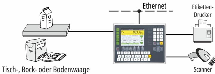
**Stichproben-Kontrollwaage gemäß der Fertigpackungs-Verordnung**
