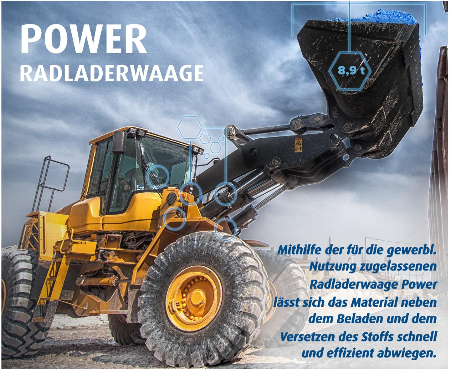
**Mithilfe der für die gewerbl. Nutzung zugelassenen Radladerwaage Power lässt sich das Material neben dem Beladen und dem Versetzen des Stoffs schnell und effizient abwiegen.**
